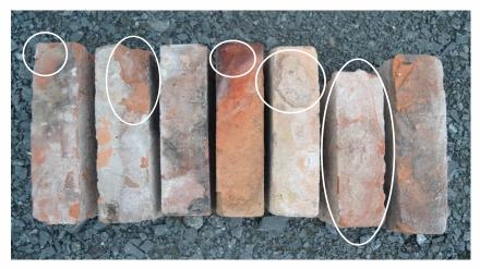
Ein Teil des Mörtels verschwindet nach dem Säubern der Fläche. Je intensiver gereinigt wird, desto mehr Mörtelreste verschwinden. Ebenfalls typisch für unsere Rückbauziegel sind, bedingt durch den Kohlebrand, Farbunterschiede zwischen den Verblendern. Auch werden Sie einen gewissen Bruchanteil in den Paletten vorfinden, der jedoch problemlos mit in Ihre Mauerwerk integriert werden kann.
